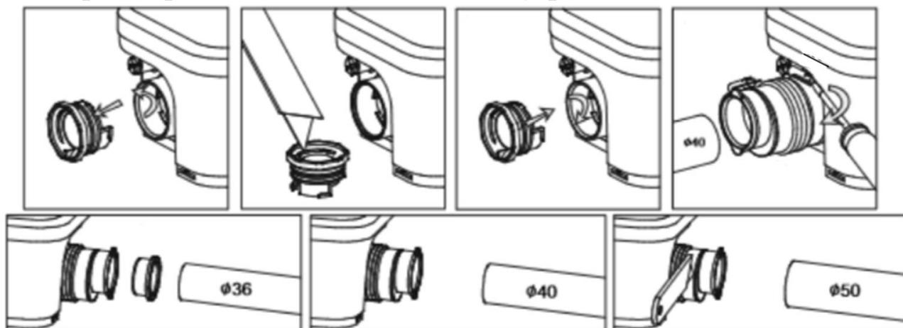
Для моделей WC601A, WC601B, WC601C: для присоединения к боковым патрубкам насоса открутите гайки и снимите соединительные патрубки. С помощью ножа прорежьте отверстие внутри патрубков, разверните их и установите на место, зафиксировав гайкой (смотрите рисунки ниже).
