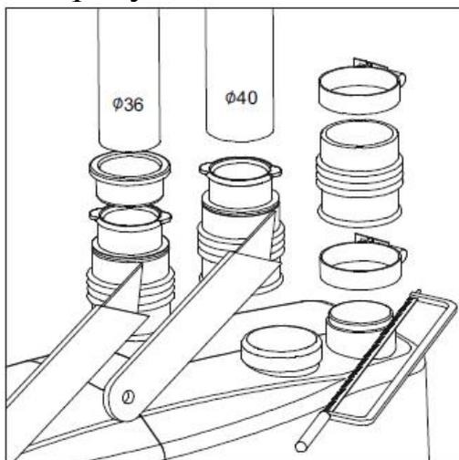
Также можно присоединить трубопровод диаметром 20 мм через крышку угольного фильтра. Для установки необходимо снять крышку, вырезать в ней отверстие при помощи ножа, надеть крышку на трубопровод и присоединить к насосу (смотрите рисунки ниже).
