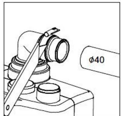
3. После горизонтальной части напорного трубопровода не должно быть вертикальной части! **Вертикальная часть трубопровода всегда должна предшествовать горизонтальной.**
